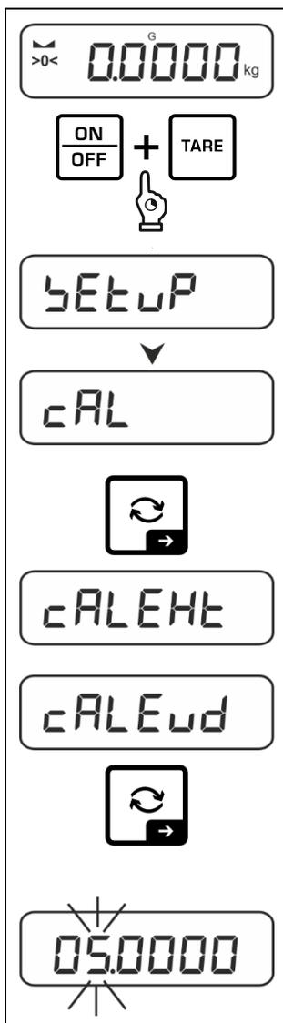
⇒ Zum Aufrufen des Setup-Menüs TARE- und ON/OFF-Taste gleichzeitig drücken und gedrückt halten.
