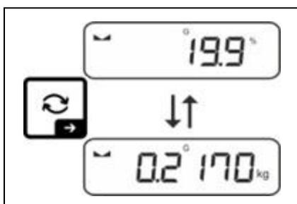
⇒ Mit der
