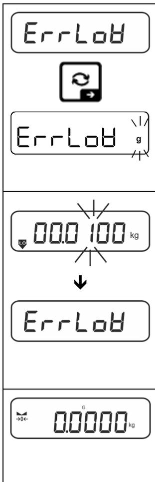
⇒ Mit den Navigationstasten  $\updownarrow$  die Einstellung  $\langle \text{ErrLoB} \rangle$  wählen und mit  $\rightarrow$ -Taste bestätigen.
