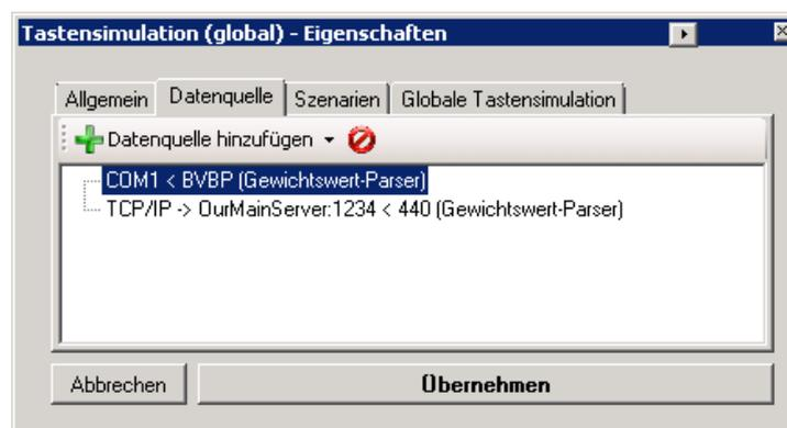
Im Reiter „Datenquelle“ sind die Eingänge oder vorgeschalteten Filter gelistet, die als Datenquellen für die Ausgabe verwendet werden. Datenpakete dieser Eingänge werden also an die Ausgabe weitergeleitet und dort verarbeitet.
