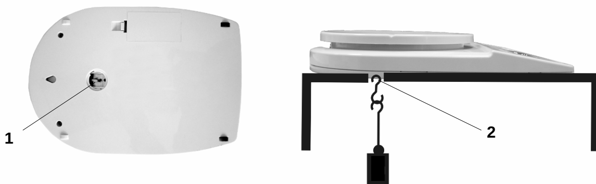
Abb. 1: Einrichten der Waage für Unterflurwägungen
